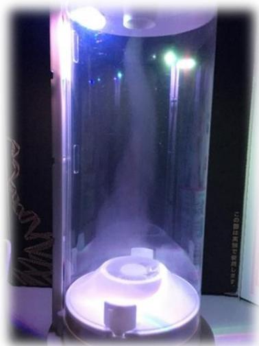
装置の上部にあるファンによって作り出される上昇気流と、側面下部にあるスリットから入る空気により、装置内にスチームの渦が作り出される装置です。渦という分野は竜巻をはじめとした地球環境をはじめ、数学や物理の分野でも研究対象となっています。
