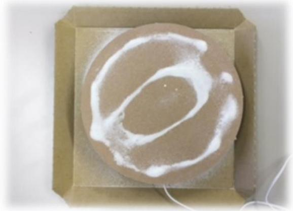
スピーカーの上に載せられた板に細かい粒子が載せられておりスピーカーによって発生される音の高さや大きさによって様々な図形が現れます。この図形はクラドニ図形とよばれ、音波はもちろん、板の材質や形によって図形が変化します。
